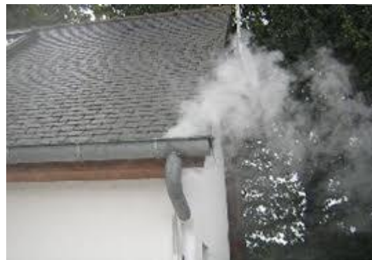
Identification de tous les organes laissant échapper de la fumée
